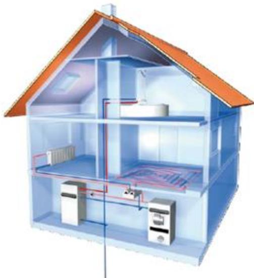
**Haus 1** Teilsaniertes freistehendes Einfamilienhaus, Baujahr 1970, Nutzfläche 150 m<sup>2</sup>, Bauweise massiv/verputzt, Standardheizkessel Öl/Gas mit indirekt beheiztem Trinkwasserspeicher, unregelte Umwälzpumpe.
