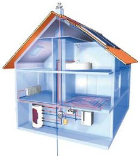
**Haus 3** Moderner Brennwertkessel (Öl/Gas), solare Trinkwassererwärmung und Heizungsunterstützung, Anpassung der Heizflächen, geregelte Pumpen, neue Thermostatventile, Dämmung der Verteilleitungen, hydraulischer Abgleich, Sanierung der Abgasleitung.
