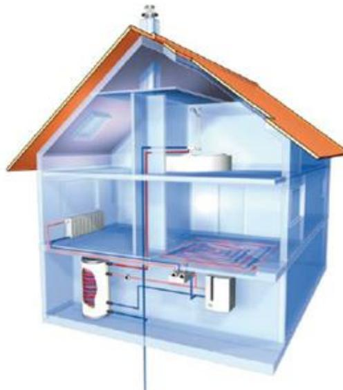
**Haus 2** Moderner Brennwertkessel (Öl/Gas) und indirekt beheizter Trinkwasserspeicher, Anpassung der Heizflächen, geregelte Pumpen, neue Thermostatventile, Dämmung der Verteilleitungen, hydraulischer Abgleich, Sanierung der Abgasleitung.
